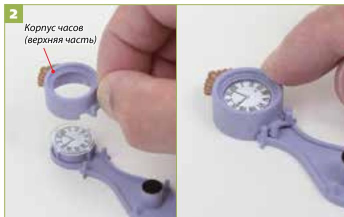
**2** Наденьте верхнюю часть корпуса (4) на заднюю часть корпуса сверху так, чтобы стекло не сдвинулось.
