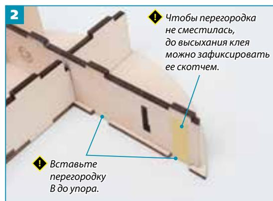
2 Закрепите перегородку В при помощи клея для дерева. Убедитесь, что выступы вставлены плотно. До высыхания клея можно закрепить перегородку при помощи малярного скотча.
